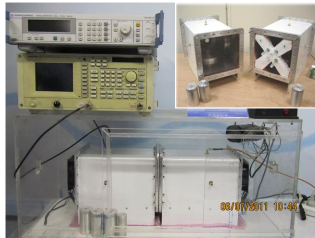
شکل ۴: موجتاب در شرایط بهره برداری. شکل داخلی: دو قسمت موجبر در حالت جدا از هم و نحوه جاسازی نمونه ها. جنس نگه دارنده نمونه ها نوعی فوم سبک است.
